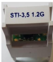
Rys. 3-6 Moduł rozgałęźnika – STI-3.5 1,2G.
