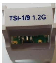
Rys. 3-7 Moduł tłumika – TSI-1/9 1,2G.
